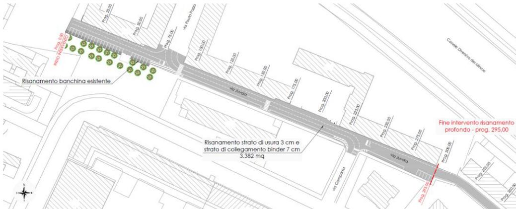
Figura 22 – Planimetria di progetto – via Juvara tratto ovest
