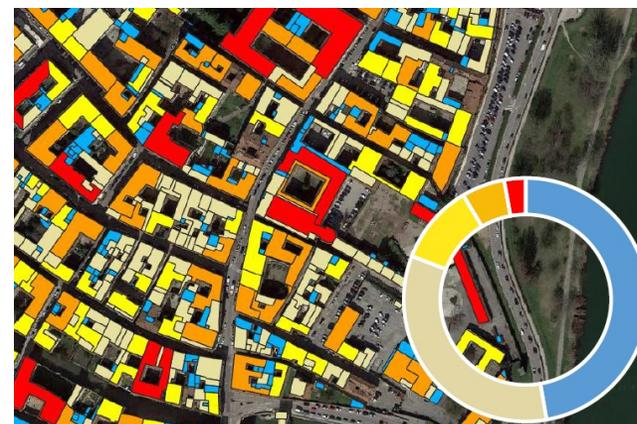
**Attraverso le informazioni ottenute utilizzando i dati acquisiti da droni, sono stati creati modelli 3D degli edifici e, sulla base dell'esposizione delle coperture, della loro pendenza e dei dati di radiazione solare, le coperture degli edifici dell'intero territorio comunale sono state classificate in base alla loro potenzialità di produrre energia**
