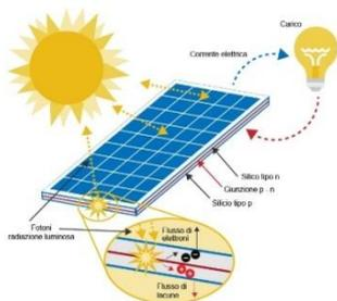
I moduli vengono poi assemblati meccanicamente in una struttura chiamata **pannello fotovoltaico**. I moduli in commercio, attualmente più diffusi (con una superficie di circa 0,5 m<sup>2</sup>), prevedono tipicamente 36 celle. I moduli rappresentano il componente elementare di qualsiasi tipo di sistema fotovoltaico. Un insieme di moduli collegati in serie costituisce **una stringa**. Mettendo in parallelo più stringhe si ottiene il cosiddetto **generatore fotovoltaico**.
